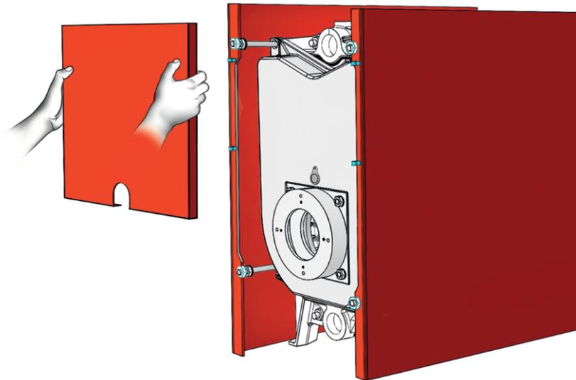
روپوش دیگ سوپر ۳۰۰ از دو قطعه جانبی، یک قطعه جلو و یک سقف تشکیل شده است که به روش ذیل مونتاژ می گردد:
