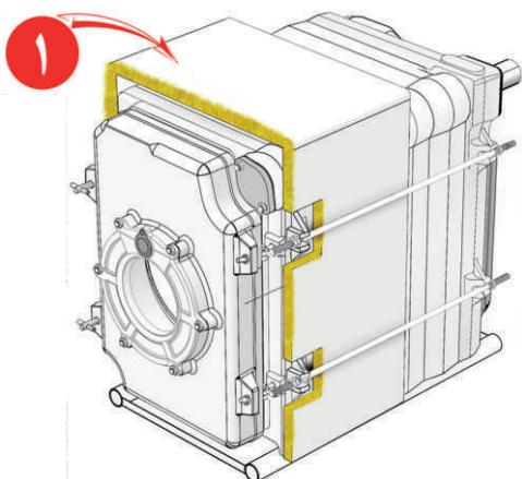
به همراه دیگ، علاوه بر روپوش، به مقدار مورد نیاز عایق حرارتی و سیم مفولی جهت بستن عایق به دور دیگ، تحویل می‌گردد.
